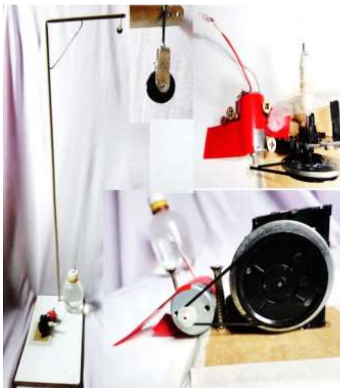
Figura 5 – Transformação de energia potencial gravitacional em elétrica. Fonte: Elaborada pelo autor.
