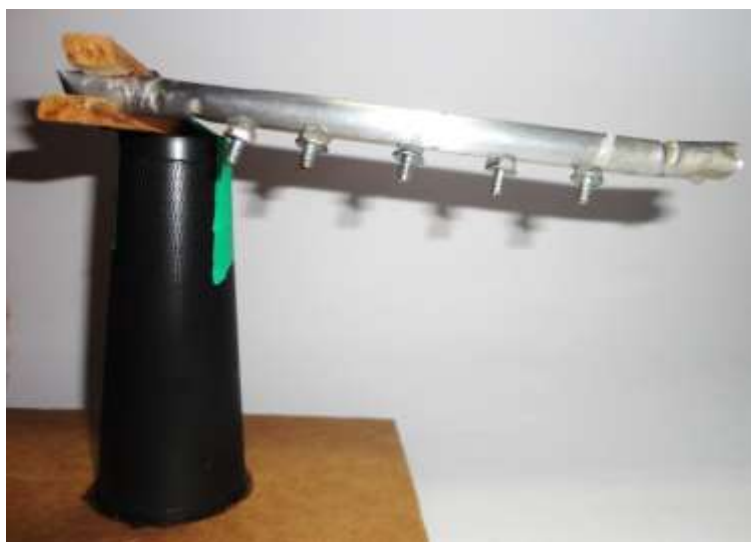
Figura 8 – Condução térmica do calor através de uma barra metálica. Fonte: Elaborada pelo autor.
