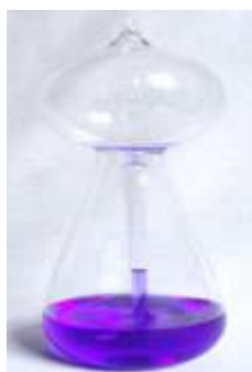
Figura 19 – Ebulidor de Franklin: ao variar a temperatura ocorre um aumento de pressão deslocando o líquido para cima. Fonte: Elaborada pelo autor.
