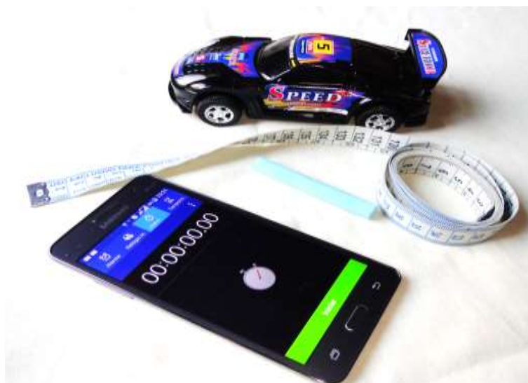
Figura 3 – Kit experimental: Velocidade Média. Fonte: Elaborada pelo autor.
