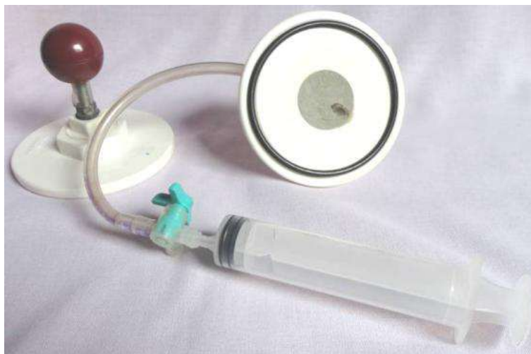
Figura15 – Placas de Magdeburg: a pressão externa pressiona uma placa fortemente contra a outra. Fonte: Elaborada pelo autor.
