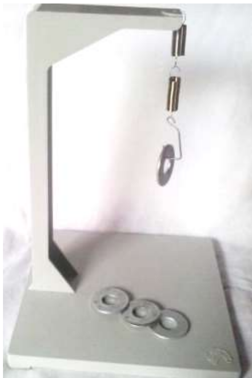
Figura 6 – Transformação de energia potencial gravitacional em elástica. Fonte: Elaborada pelo autor.
