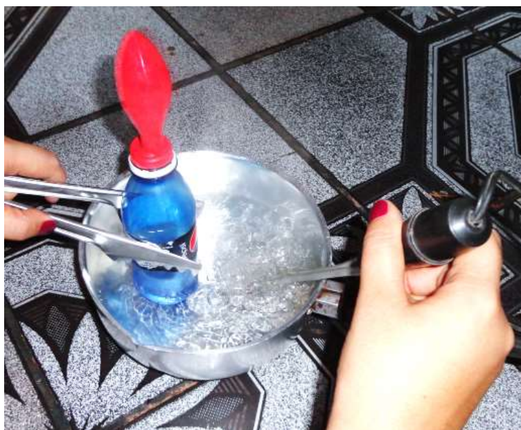
Figura 9 – Dilatação gasosa. Fonte: Elaborada pelo autor.
