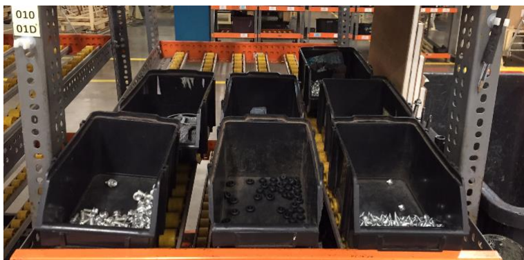
Figura 43 - Estantes de linha de produção com as caixas plásticas contendo peças de pequena dimensão.
