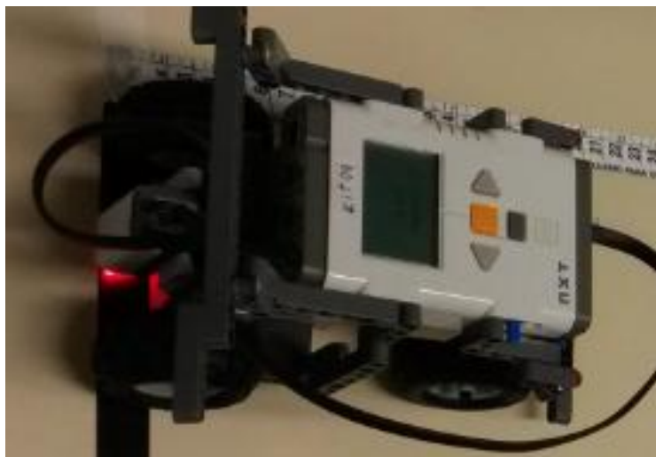
Figura 11: Foto do momento em que o carro-robô detecta a faixa preta e registra o tempo que percorreu uma determinada distância na tela do seu brick.
