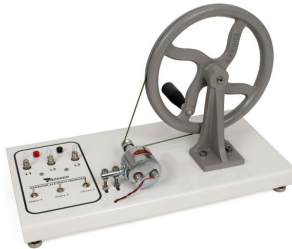
Figura 12 – Gerador elétrico de bancada.
