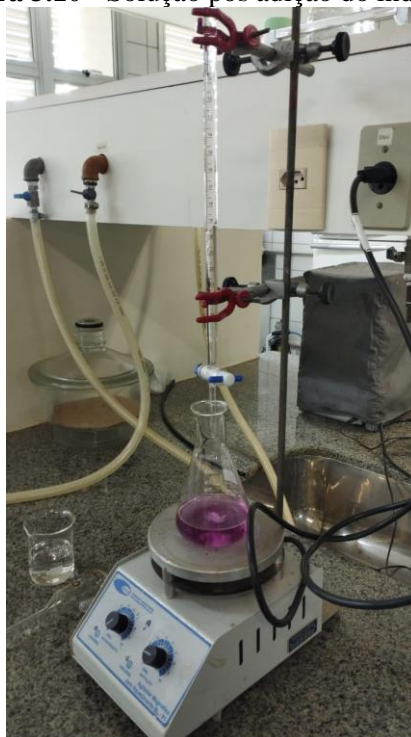
Figura 3.10 - Solução pós adição do indicador
