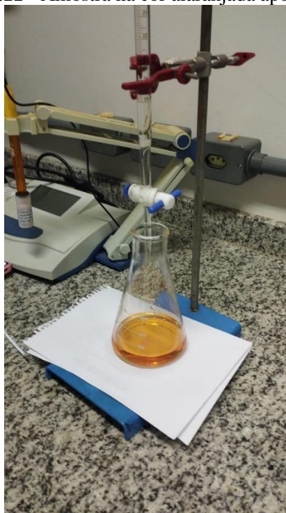
Figura 3.11 - Amostra na cor alaranjada após titulação
