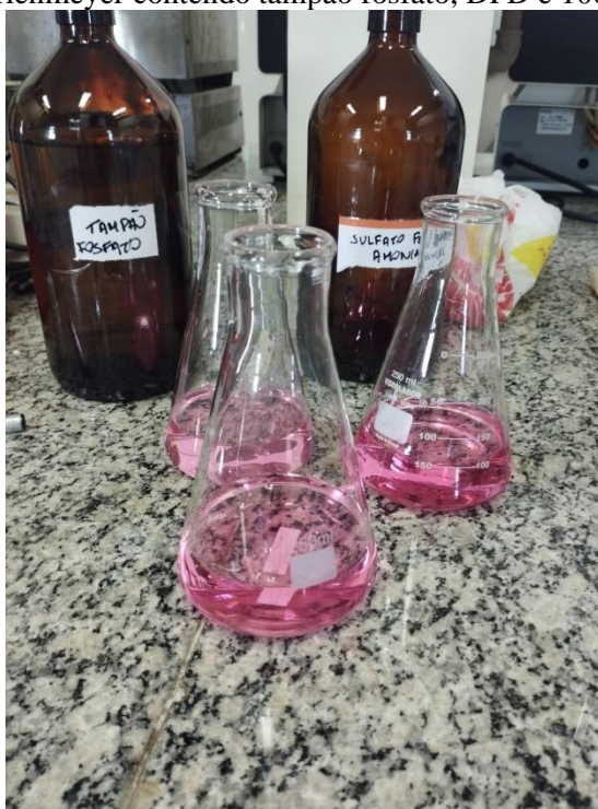
Figura 3.9 - Erlenmeyer contendo tampão fosfato, DPD e 100 mL de amostra
