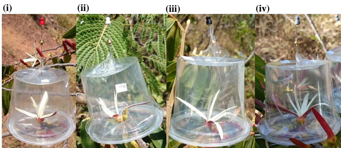
FIGURA 3.2 - Extração in vivo dos COVs das flores de X. aromatica utilizando os revestimentos: (i) PDMS, (ii) PA, (iii) CAR/PDMS e (iv) DVB/CAR/PDMS
