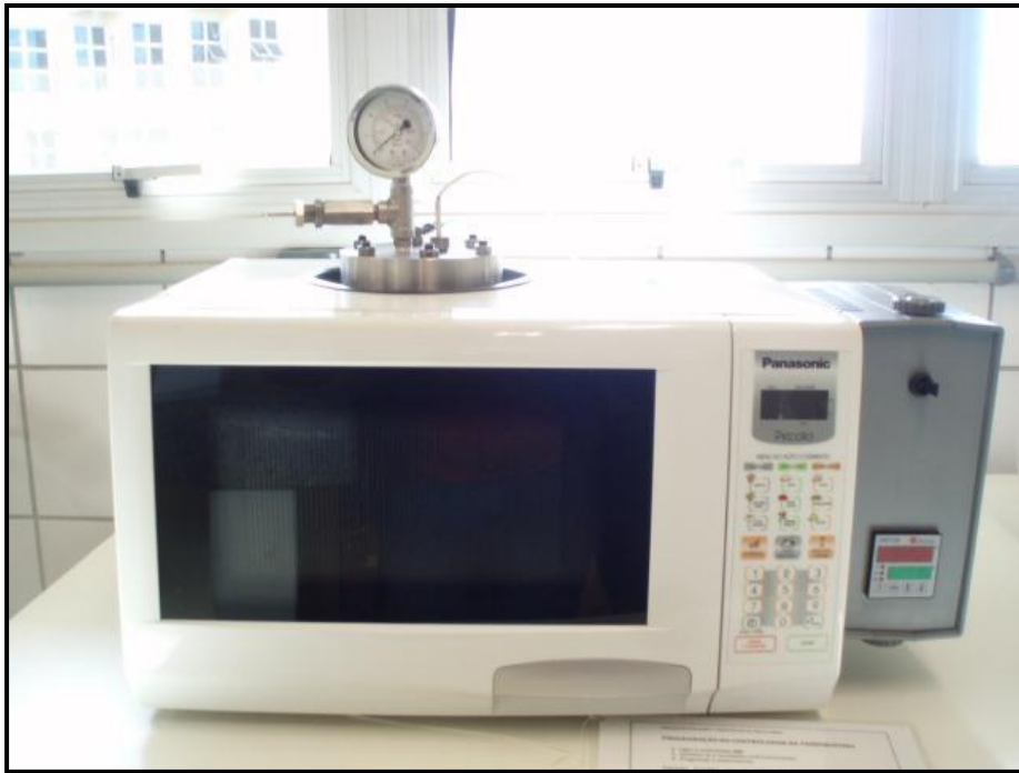
Figura 1.5: Sistema hidrotérmico assistido por micro-ondas. [44]
