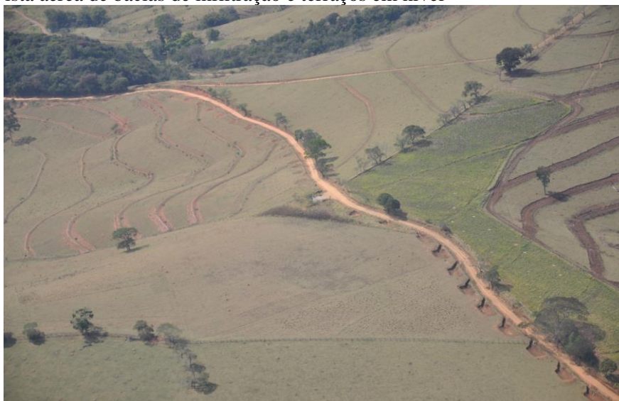
Figura 13 - Vista aérea de bacias de infiltração e terraços em nível
