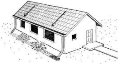
Figura 2.12 – Área de coleta: telhado inclinado
