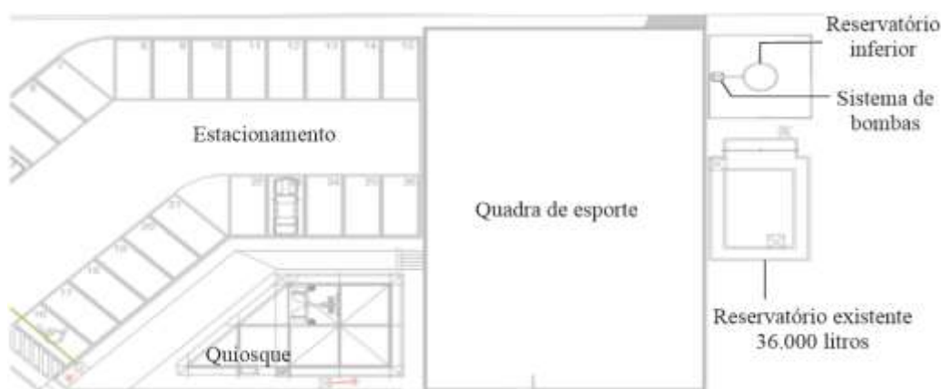
Figura 3.16 – Localização do reservatório inferior
