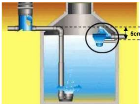
Figura 2.19 – Esquema de instalação do sifão ladrão
