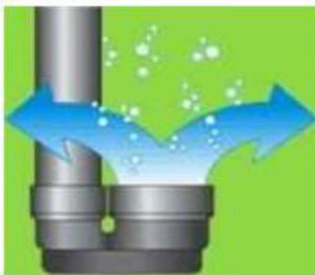
Figura 2.18 – Princípio do funcionamento do freio de água
