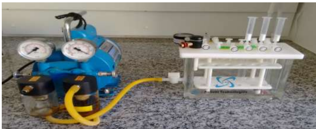
Figura 17: Sistema de extração a vácuo (manifold).
