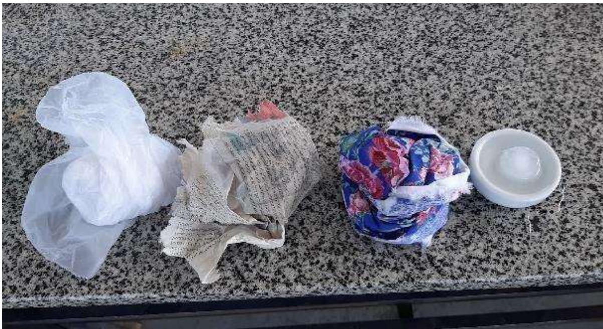
Figura 6.13 – Materiais utilizados para comparação de isolantes térmicos
