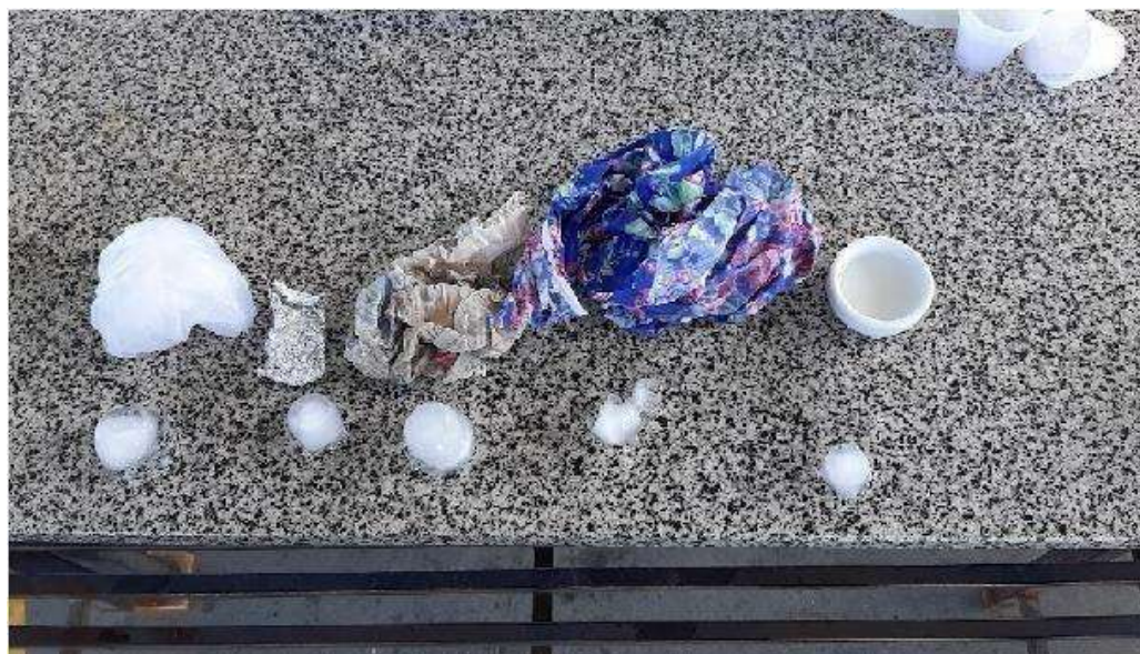
Figura 12 – Isolantes térmicos com a respectiva quantidade de gelo após o experimento
