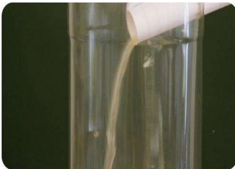
Figura 20 – Demonstração experimental do escoamento laminar da fumaça.
