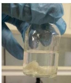
FIGURA 14: Recipiente contendo o tecido sol-gel em solução aquosa à 0,08 \mu\text{g mL}^{-1} de E1, EE2 e BPA.
