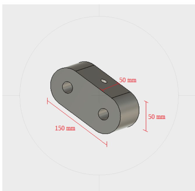
Figura C.5 – Dimensões para os elos auxiliares no sistema de transmissão do dispositivo ortético.
