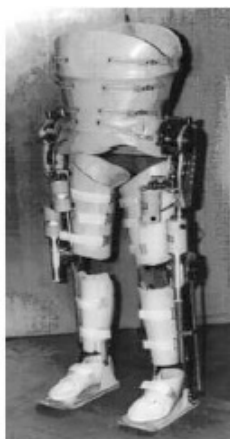
Figura 3.10 – Dispositivo ortético dinâmico ativo de Vukobratovic.
