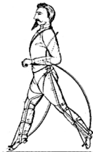
Figura 3.8 – Dispositivo ortético mecânico do tipo exoesqueleto de Yagn (1890).
