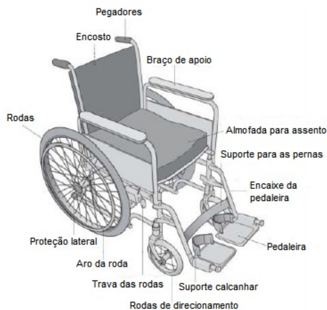
Figura 3.3 – Modelo de cadeira dobrável e seus componentes.
