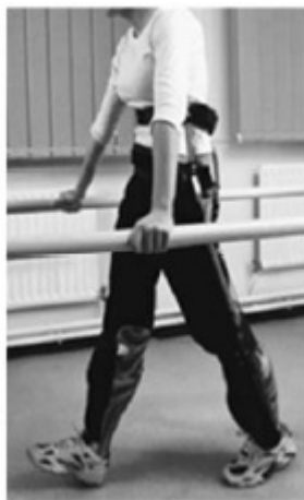
Figura 1.1 – Modelo de órtese atuante no quadril, joelho, tornozelo e pé.
