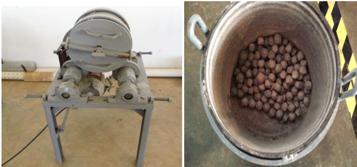
Figura 17. Moinho de bolas utilizado na cominuição das amostras.
