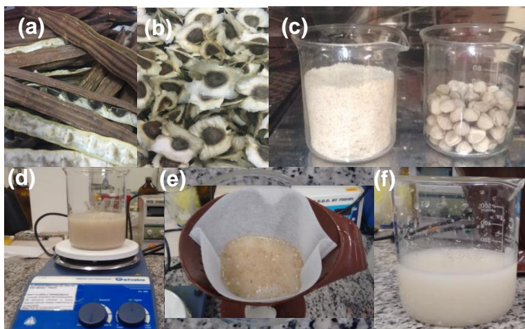
Figura 2. Sequência de preparo do EAMO. (a) Vagem, (b) Sementes com casca, (c) sementes trituradas e sementes sem a casca, (d) agitação e preparação do EAMO, (e) filtração do EAMO e (f) EAMO após a filtração.
