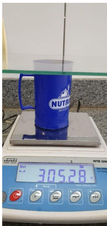
Figura 3-7 - Volume de referência utilizado na dosagem dos traços
