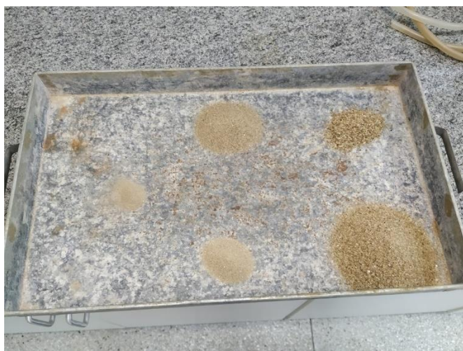
Figura 3-3 - Disposição dos grãos de areia após o peneiramento
