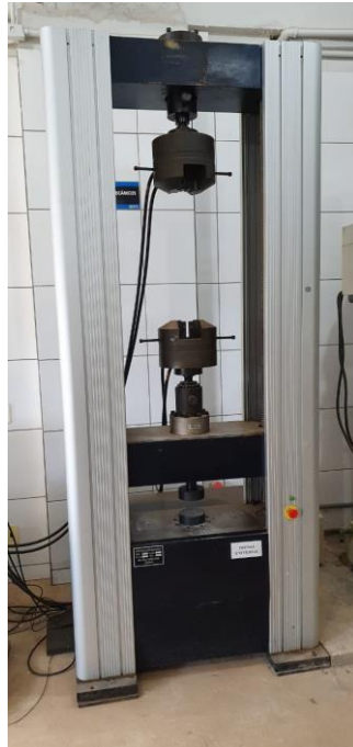
Figura 3-14 - Prensa universal do laboratório de estruturas
