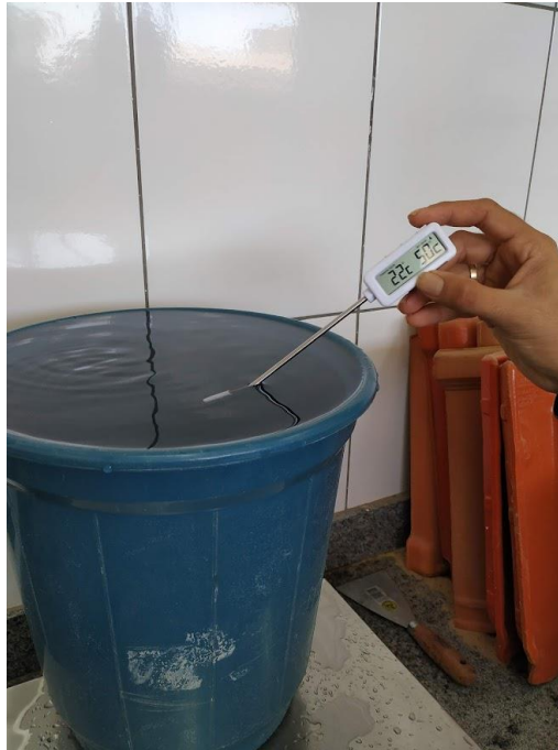
Figura 3-4 - Verificação da temperatura da água no cálculo do volume
