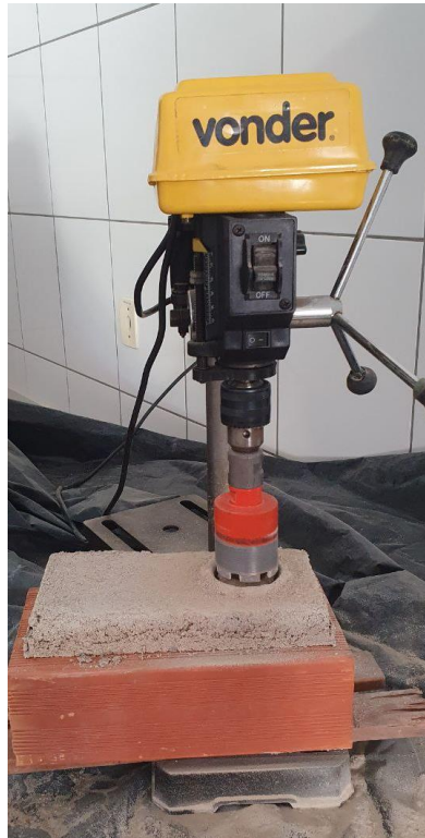
Figura 3-18 - Perfuração da argamassa no bloco
