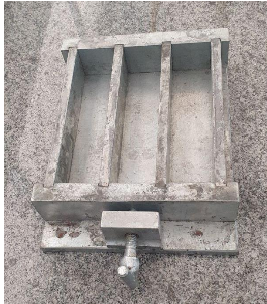
Figura 3-11 - Fôrmas utilizadas na moldagem dos corpos de prova
