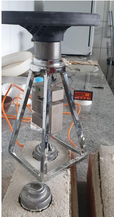
Figura 3-19 - Ensaio de arrancamento
