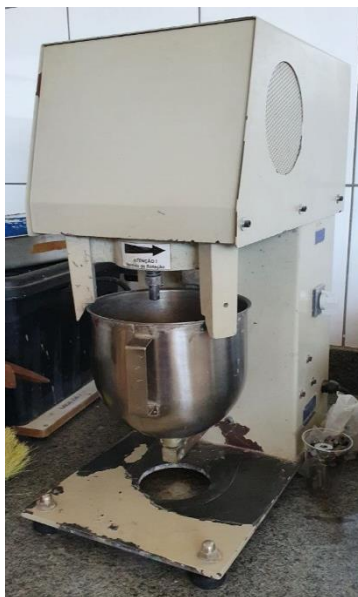
Figura 3-9 - Argamassadeira utilizada na fabricação dos traços
