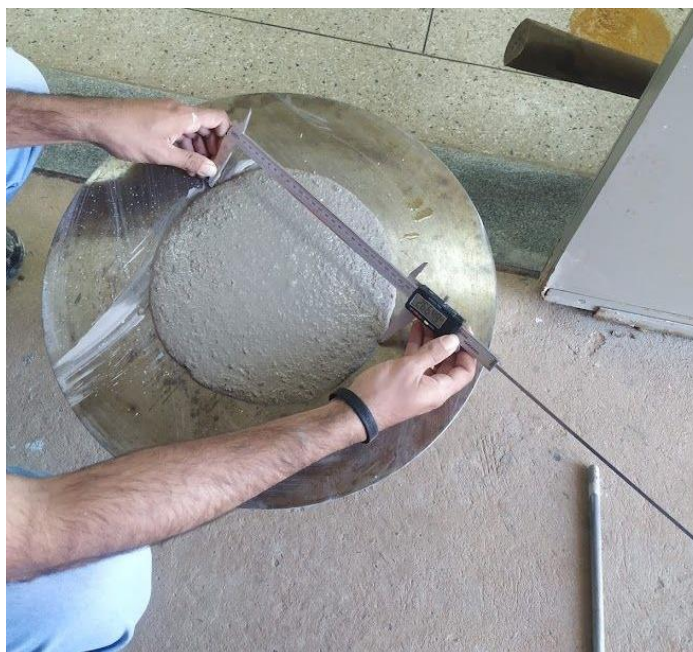
Figura 3-12 - Medição do espalhamento da argamassa
