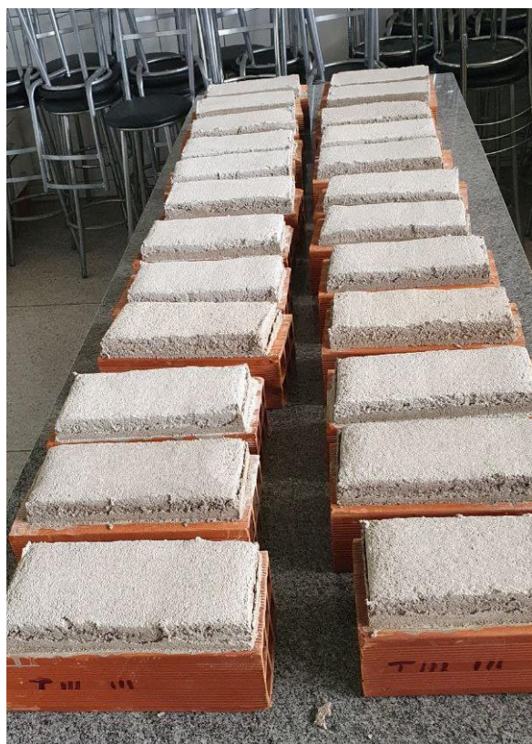
Figura 3-17 - Blocos com camada de argamassa
