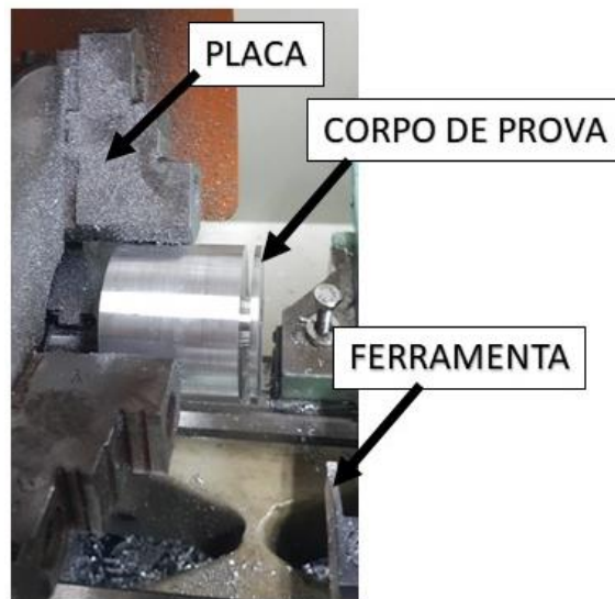
Figura 41 – Corpo de prova durante preparação
