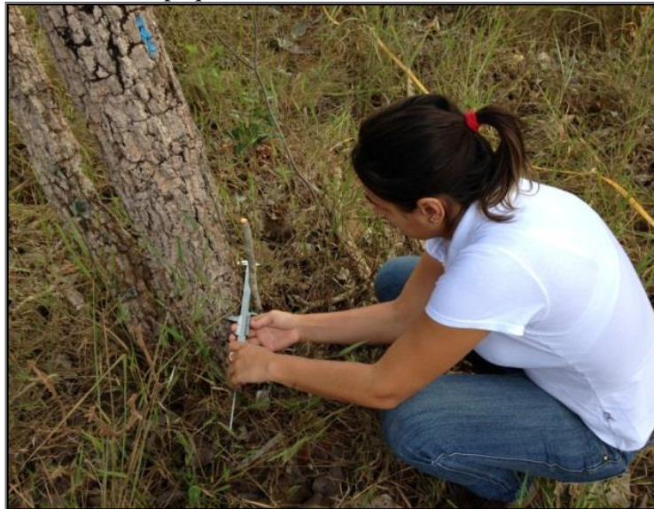
Foto 4 - Goiandira (GO): determinação do diâmetro com o auxílio de um paquímetro– 2016.
