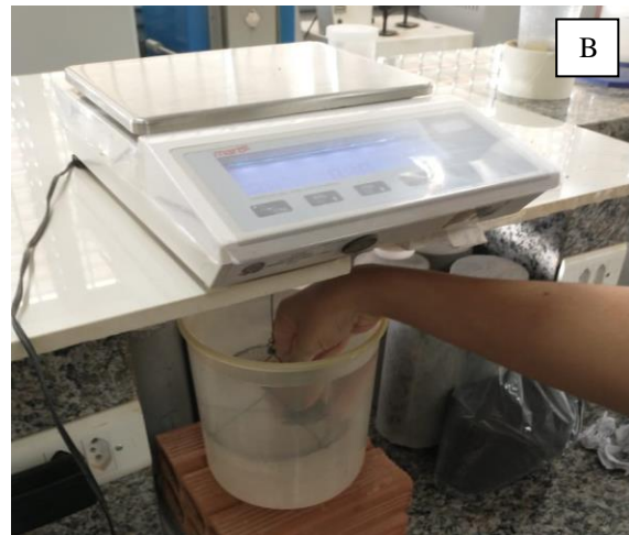
Figura 20 – Ensaio de Porosidade aparente: a) coleta de amostra, b) balança hidrostática, c) preparação das amostra e d) liofilizador
