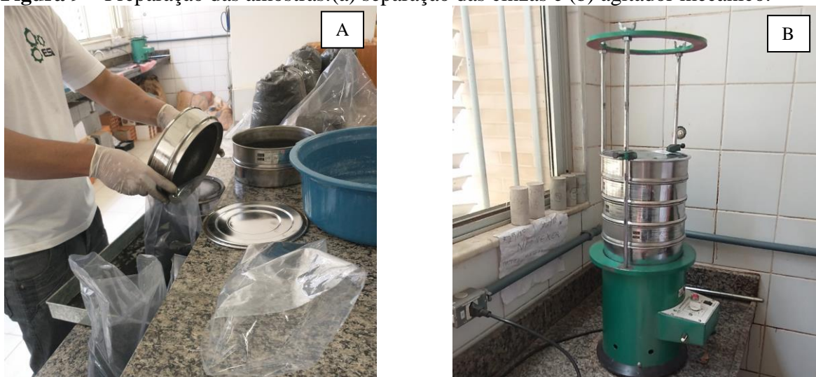
Figura 9 – Preparação das amostras:(a) separação das cinzas e (b) agitador mecânico.
