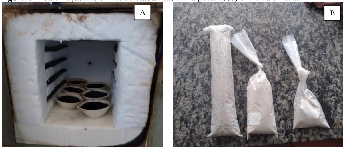
Figura 8 – Calcinação das cinzas coletadas: (a) cinza pesada; (b) cinza calcinada.
