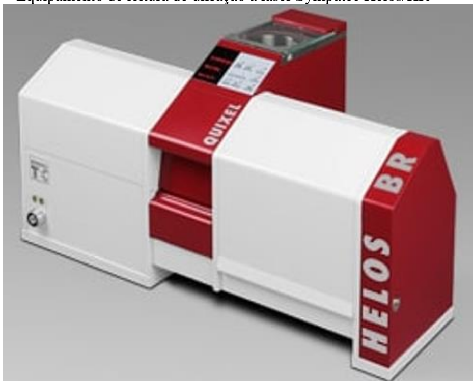
Figura 10 – Equipamento de leitura de difração a laser Sympatec Helos/KR
