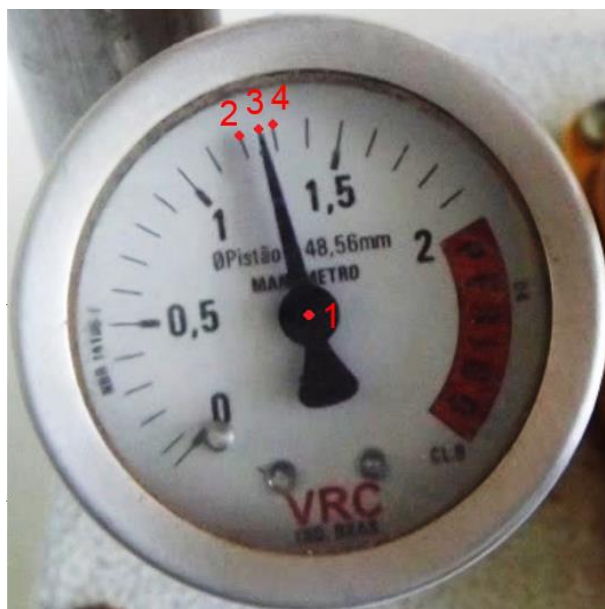
Figura 15. Imagem do manômetro e os pontos de coleta das coordenadas para o cálculo da carga de ruptura.
