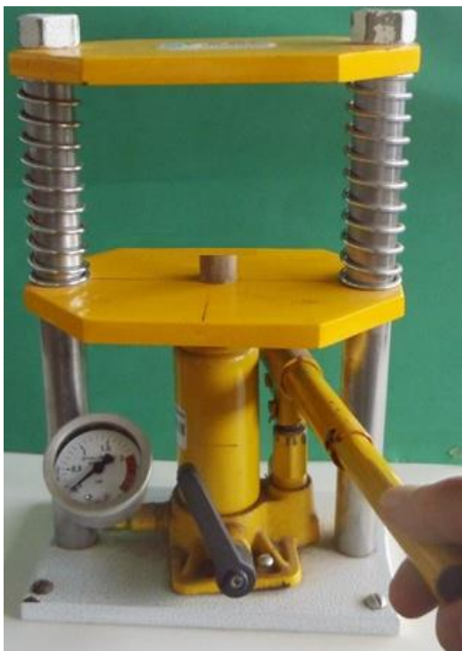
Figura 14 - Manômetro utilizado nos testes de compressão uniaxial. Fonte: Elaborado pelo próprio autor.
