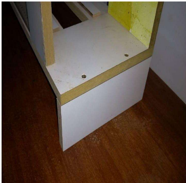
Figura: Junção da base principal com suporte pé. Fonte: elaborada pelo autor.
