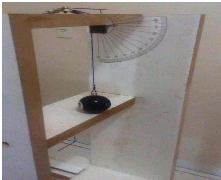
Figura 4 – Passo 9. Fixar a bola de sinuca ao fio de ‘náilon’ e fixa o Transferidor a peça lateral (2) com auxílio de cola super bonder como ilustrado. Junção do fio de ‘náilon’ com a bola de bilhar a peça lateral (2). Fonte: Autor.
