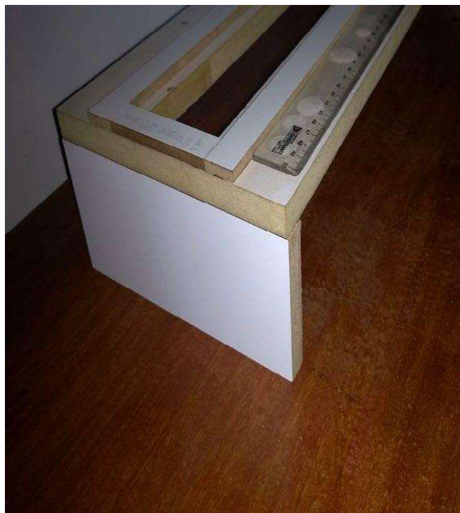
Figura: Junção da base principal com suporte pé. Fonte: elaborada pelo autor.
