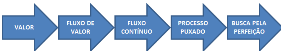
Figura 6 – Fluxo de verificação baseado nos princípios da Manufatura Enxuta
