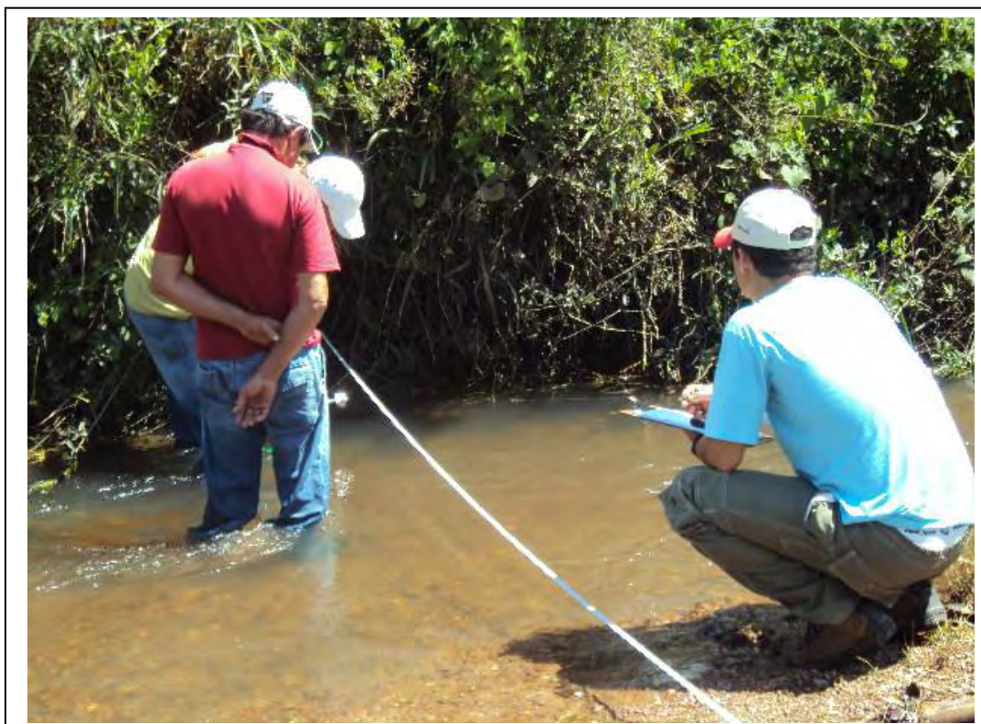
Foto 03: Medição da vazão do Ribeirão Sapé no Alto do Sapé (montante) em 13/04/2011.
