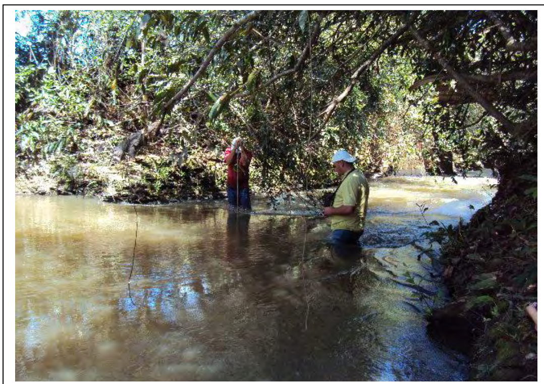
Foto 04: Medição da vazão do Ribeirão Sapé no Mangueirão (jusante) em 13/04/2011. Org.: MARTINS, R. P. (2011).
