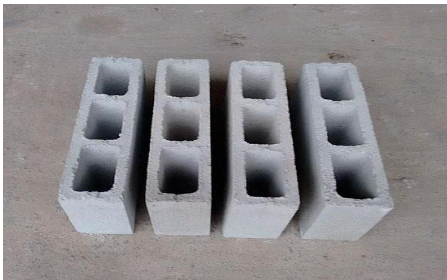
Figura 4 - Bloco de concreto
