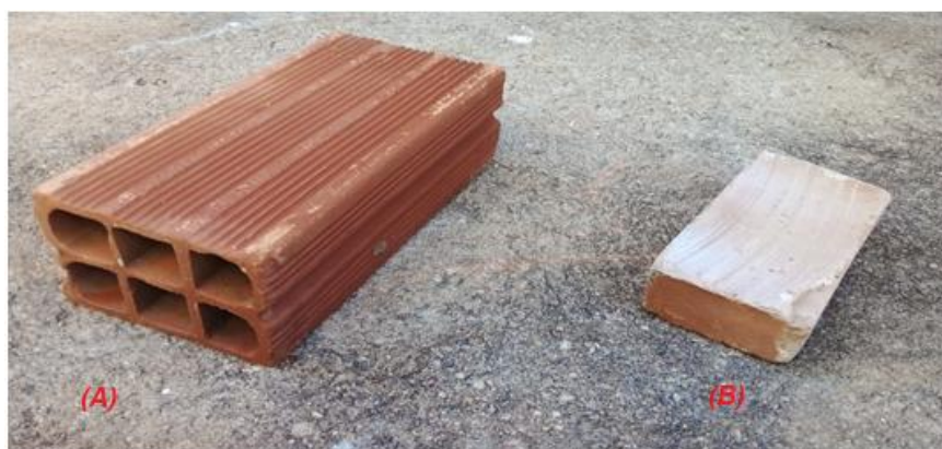
Figura 3 - Blocos cerâmicos: furado (A) e maciço (B)
