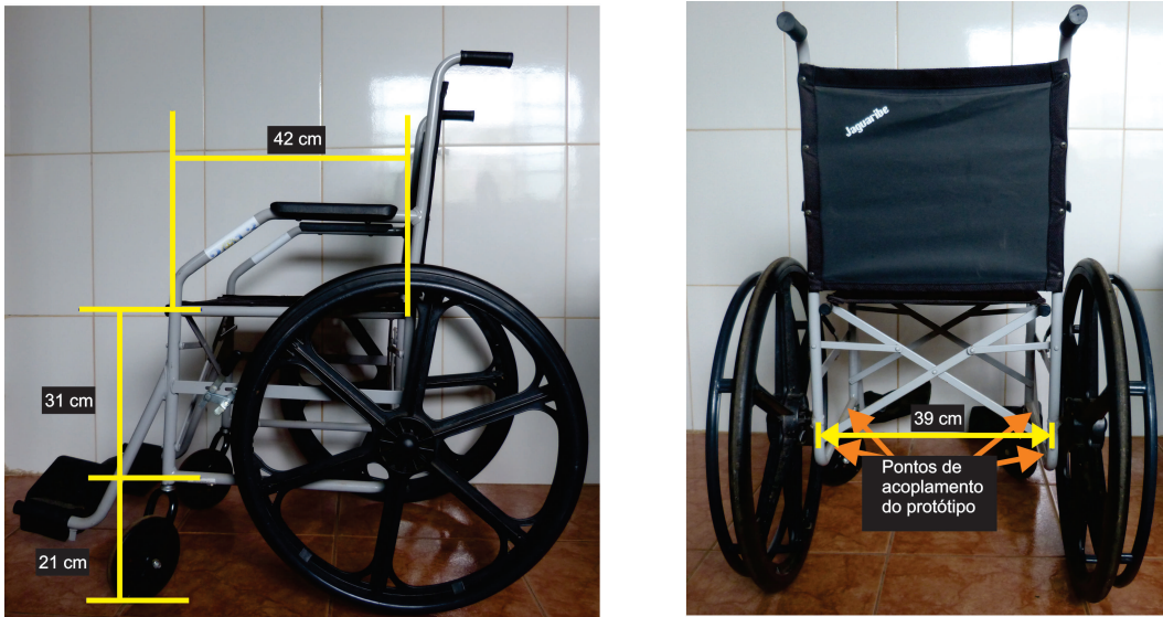
Figura 68 – Cadeira de rodas - medidas consideradas
