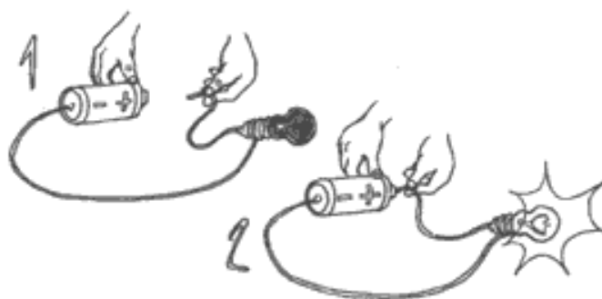
Figura 2.6. (1) Circuito aberto e (2) circuito fechado.
