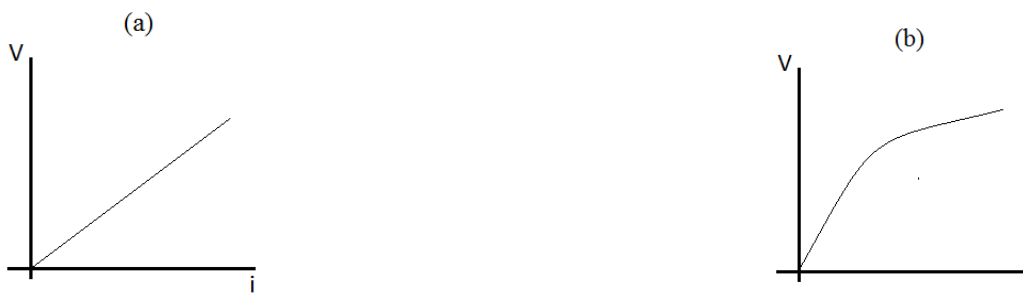
Figura 1.3. (a) Gráfico da tensão aplicada V em função da corrente i para resistores ôhmicos e (b) exemplo de resistor não-ôhmico.
