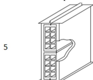
Figura 7.2.4 – Parede pré configurada em planilha conforme a NBR 15220/3
