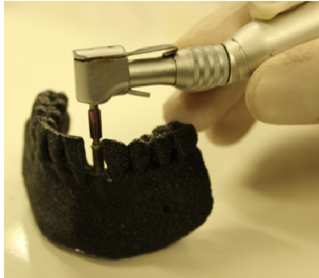
Figura 4.12 – Instalação do implante a 30 rpm e torque de 60 N .
