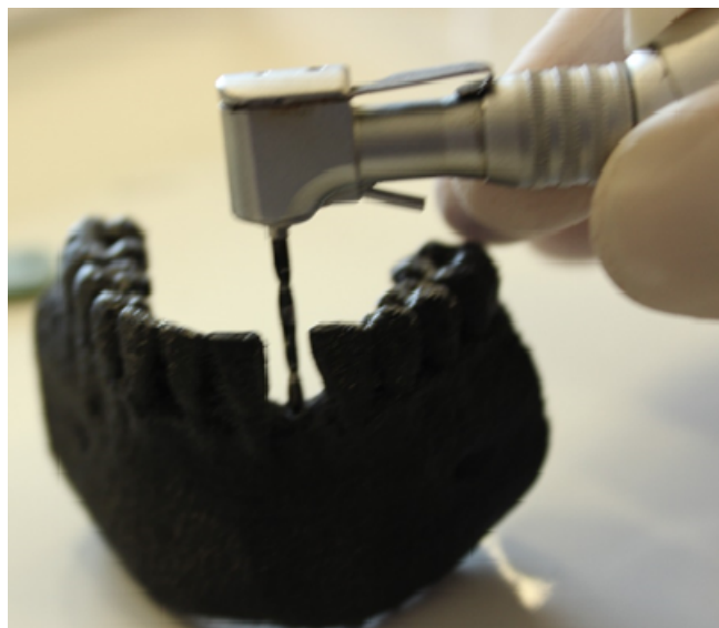
Figura 4.8 – Trabalhando de 500 a 800 rpm com a broca alvin 2.0.
