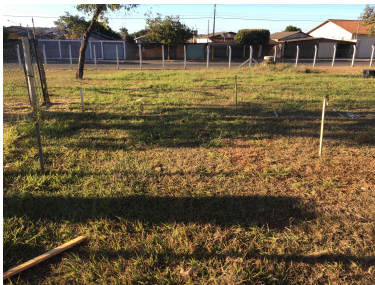
Figura 3.5 – Malha quadrática de coleta de amostra em 4mX4m
