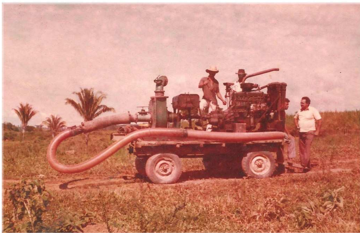
Figura 43 - Na foto acima, também cedida pela S ra Maria Pereira Saldanha, Roldão Pereira Carneiro vistoria uma draga, equipamento que facilitou a retirada de cascalho do fundo do rio, trabalho que antes desse maquinário só podia ser feito depois de construídas as viradas ou à custa do mergulho dos garimpeiros.
