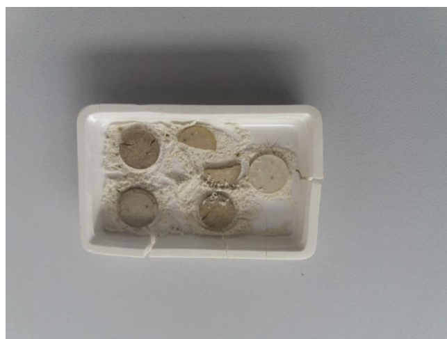
Figura 11 - Aspecto das pastilhas pós-sinterização
