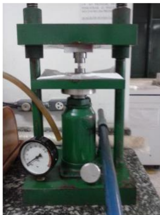
Figura 9 - Prensa e molde para conformação das pastilhas de BCO e BCYO
