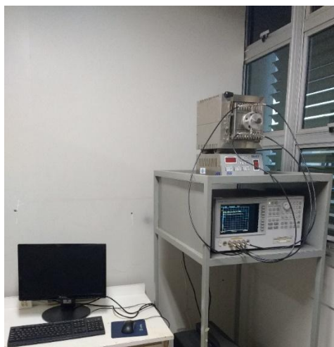
Figura 12 - Aparato utilizado para estudo da condutividade protônica
