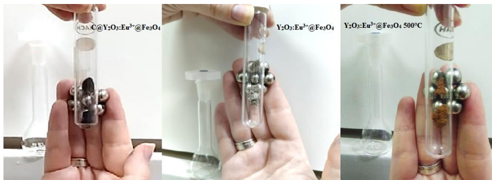
Figura 4.4.2. Magnetização dos materiais C@Y_2O_3:Eu^{3+}@Fe_3O_4 , Y_2O_3:Eu^{3+}@Fe_3O_4 e Y_2O_3:Eu^{3+}@Fe_3O_4 500°C frente a ímãs de neodímio.
