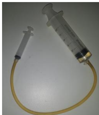
Figura 17 – Foto da prensa hidráulica utilizada no experimento. (Fonte: Arquivo pessoal)
