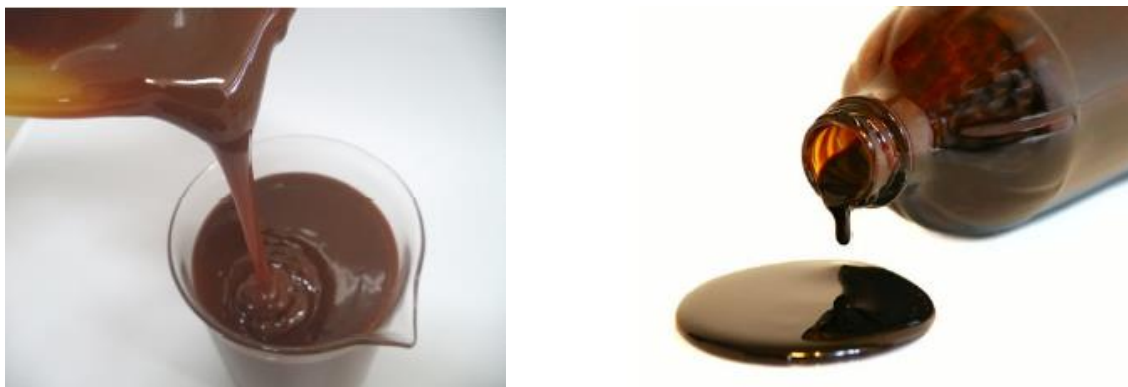
Figura 8: Melaço de soja utilizado nos processos de aglomeração de finos de calcário
