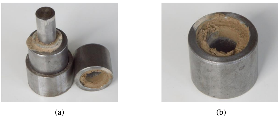
Figura 15: Moldes da briquetadeira apresentando extrusão do material com 10% de aglomerante em sua composição.
