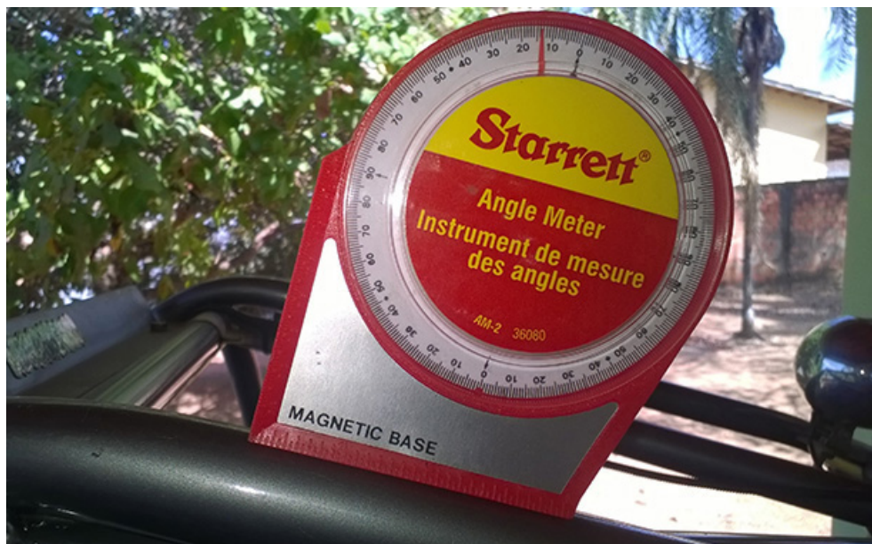
Figura 6.5 – Inclinação da barra que faz ligação entre o arco principal e o arco secundário.
