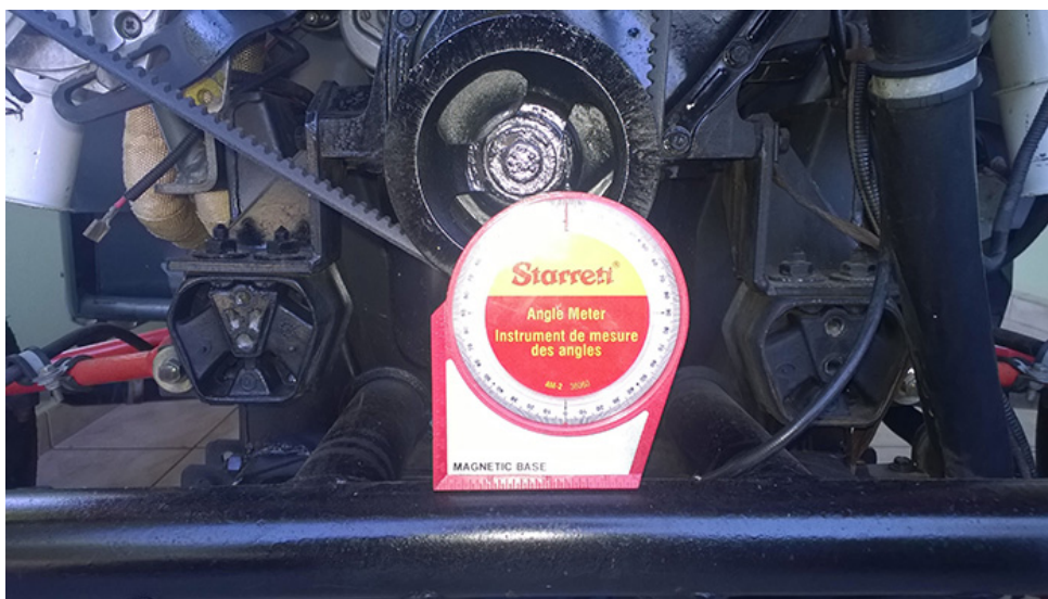
Figura 6.7 – Goniômetro sobre o para-choque traseiro.
