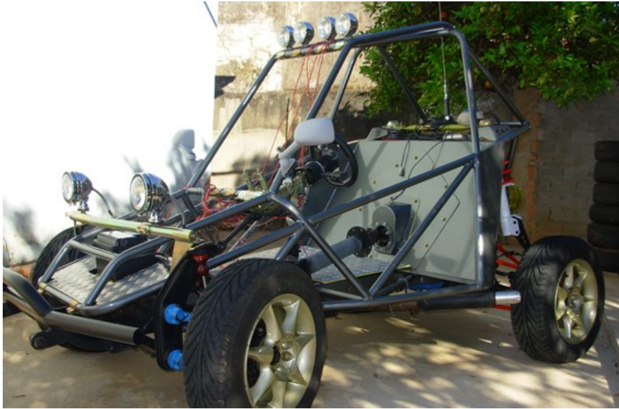
Figura 6.2 – Veículo experimental parcialmente desmontado, mostrando o chassi spaceframe .
