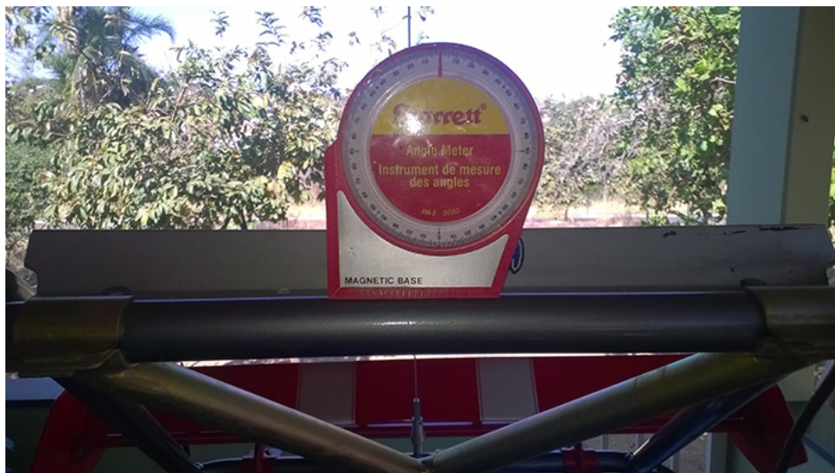
Figura 6.9 – Medição no teto do veículo.
