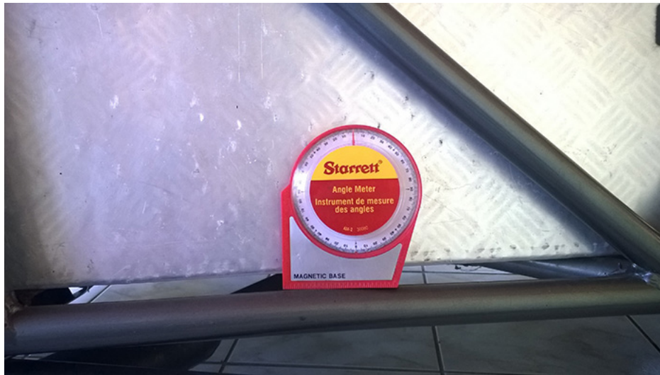
Figura 6.8 – Medindo a lateral do veículo.
