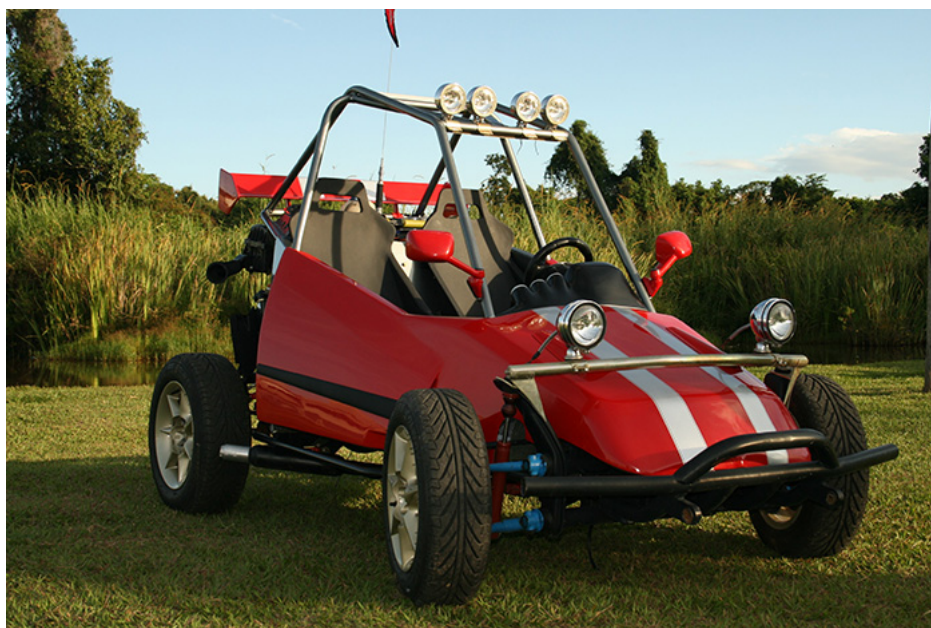
Figura 6.1 – Veículo experimental montado, com carenagem de fibra de vidro.
