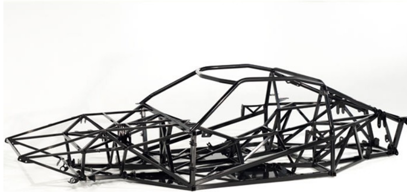
Figura 5.6 – Chassi treliçado tridimensional.
