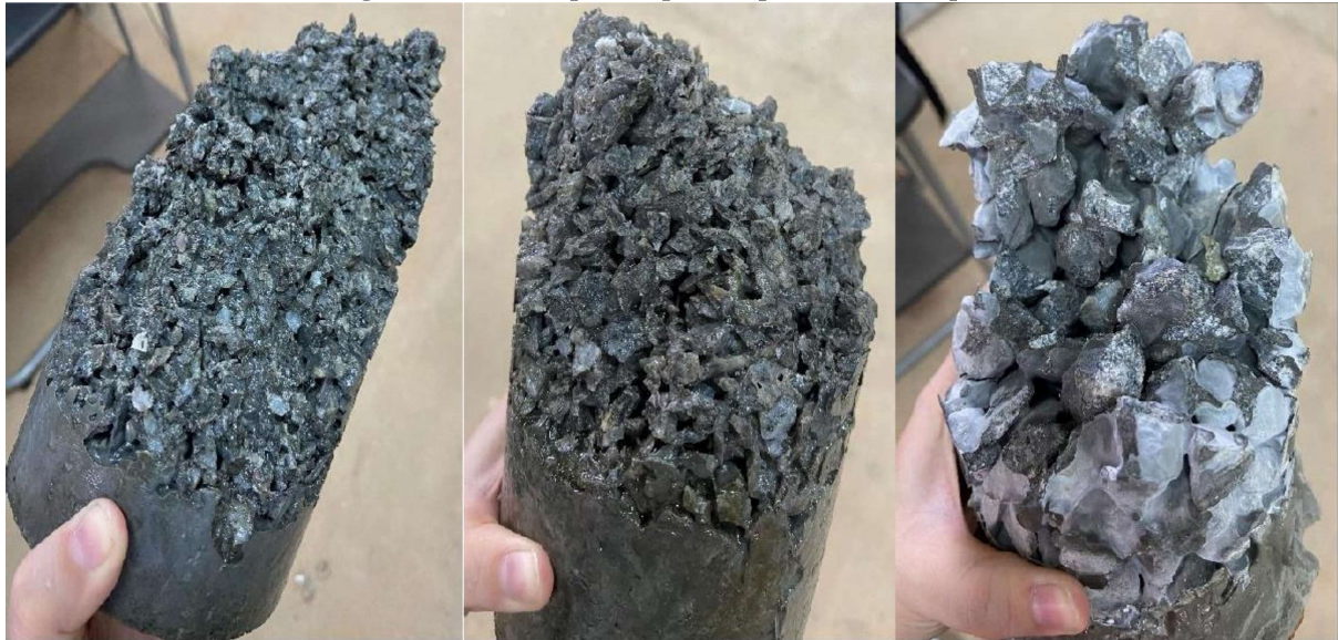
Figura 6.13 – Corpos de prova após serem rompidos.
