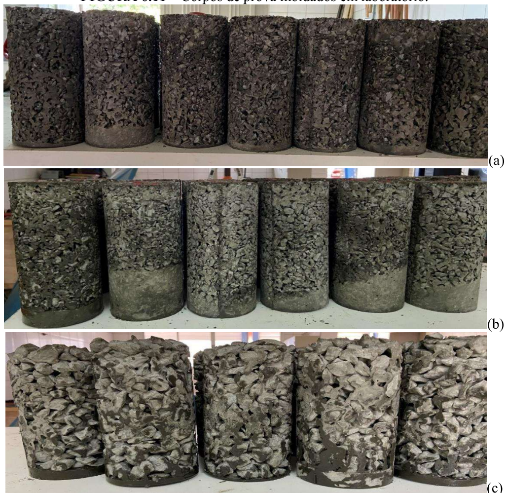
(a) Amostras referentes ao traço 1; (b) Amostras referentes ao traço 2; (c) Amostras referentes ao traço 3.
