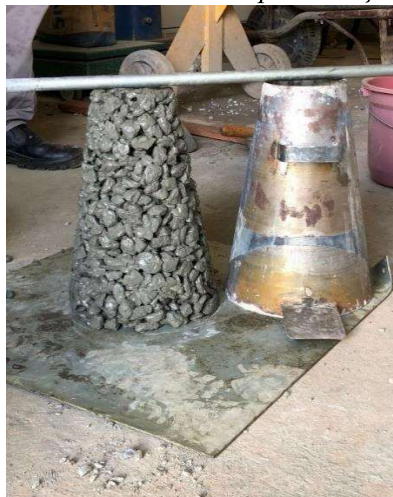
FIGURA 6.10 – Slump test traço 3.
