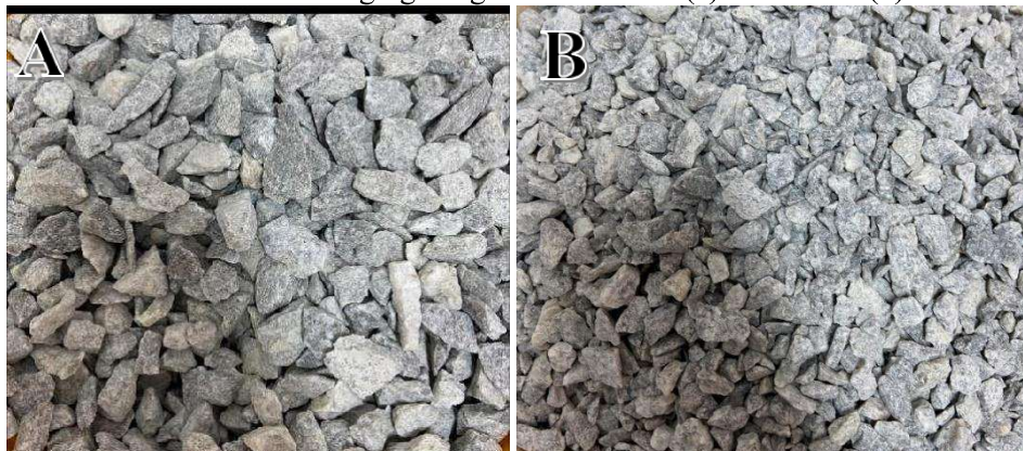
FIGURA 5.2 – Agregado graúdo “brita 1” (a) e “brita 0” (b).
