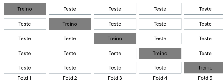
Figura 13. Exemplo de validação cruzada. Caixas cinzas correspondem ao grupo de teste, enquanto as brancas correspondem ao grupo de treino. No eixo x, são representados os diferentes grupos K . Fonte: (adaptado de Müller et al. , 2016).
