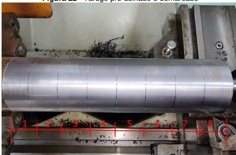
Figura 22 - Tarugo pré-usinado e demarcado
