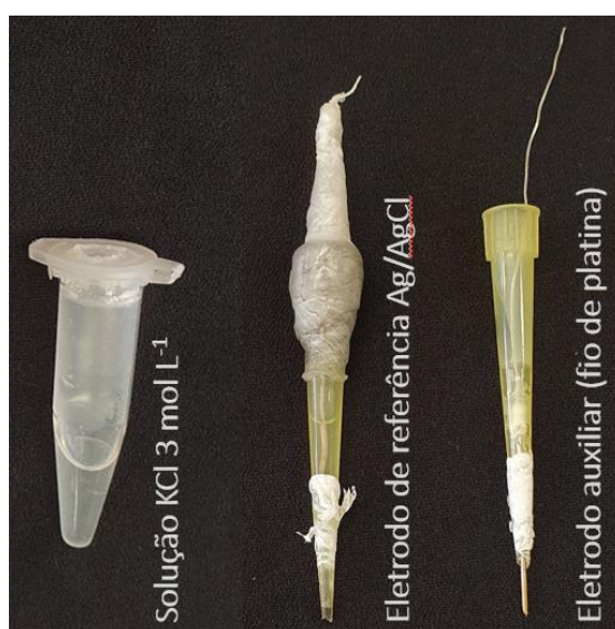
Figura 41. Eletrodo de referência, eletrodo auxiliar e o frasco modificado com KCl para armazenar o eletrodo de referência.
