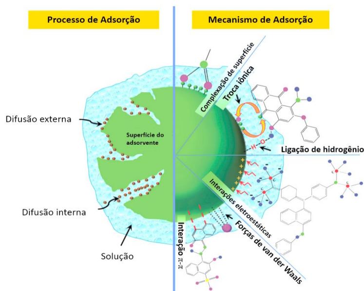
Figura 3. Esquema do processo e mecanismo de adsorção.
