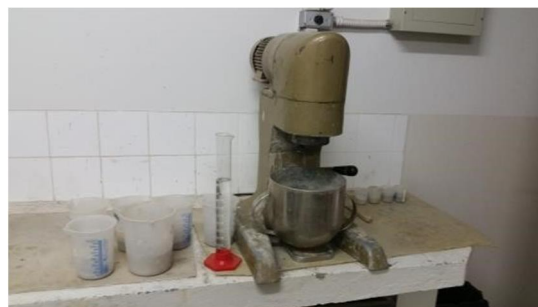
Figura 3 . Preparação da argamassa
