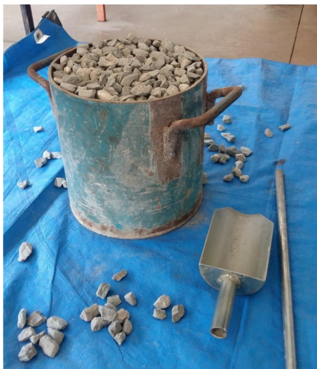
Figura 15 - Determinação da massa unitária com recipiente de volume conhecido juntamente com a haste de adensamento e concha para auxílio do enchimento.
