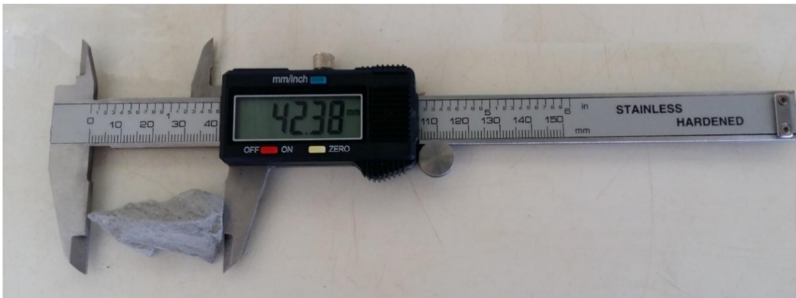
Figura 16 - Uso de paquímetro digital para medição dos grãos.
