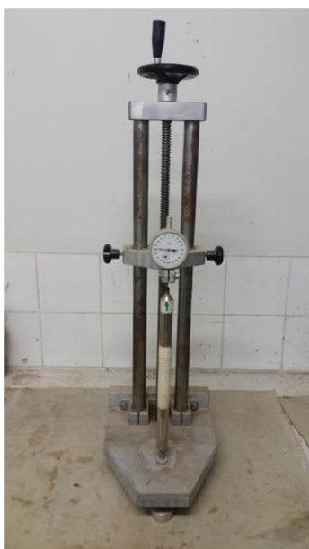
Figura 6 . Aparato para medição das barras
