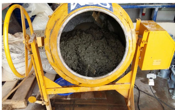
Figura 19 - Betoneira de 150 L utilizada para a fabricação dos concretos.
