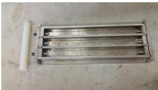
Figura 2 . Fôrma para moldagem das barras
