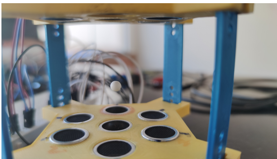
Figura 1.1 – Exemplo de Levitador acústico de eixo único com ajuste de fases, levitando uma partícula em um ponto focalizado
