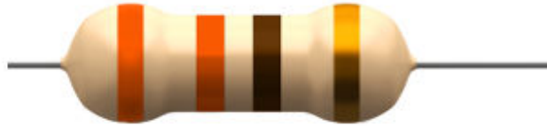
Figura 5.4: Exemplo de resistores de cores
