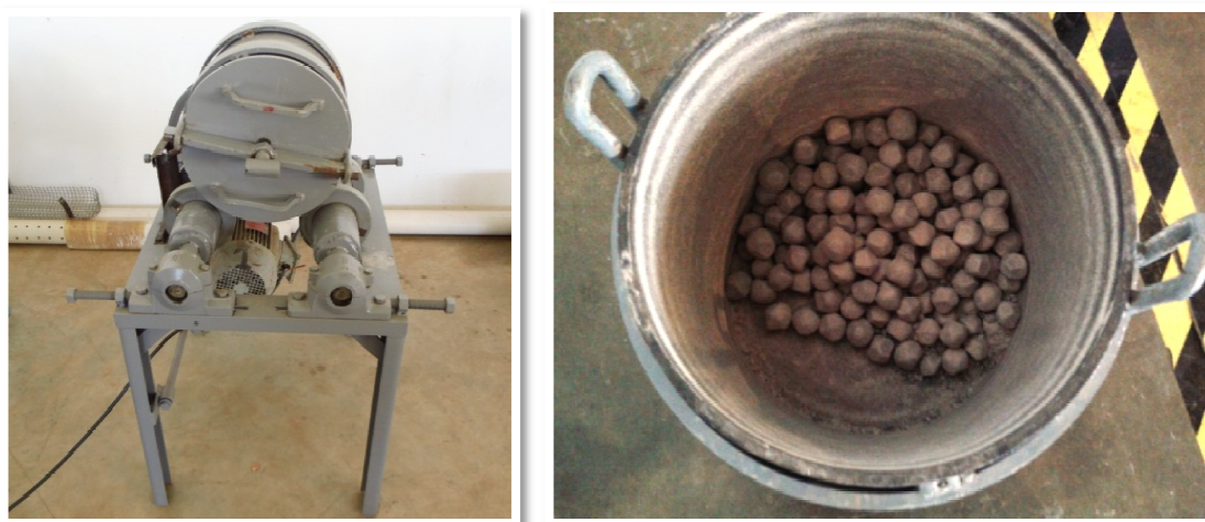
Figura 19 – Moinho de bolas utilizado na cominuição da apatita
