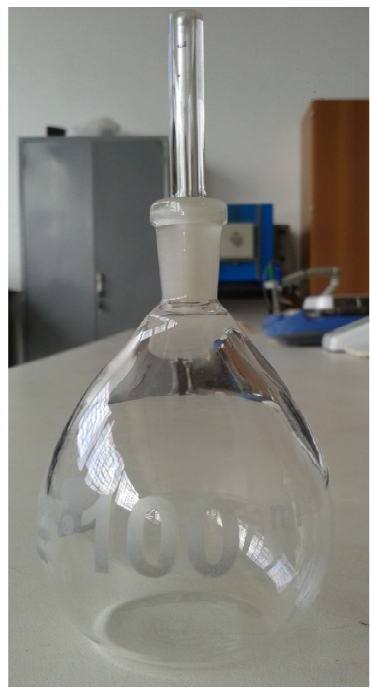
Figura 22 – Picnômetro utilizado na determinação da massa específica das amostras de apatita
