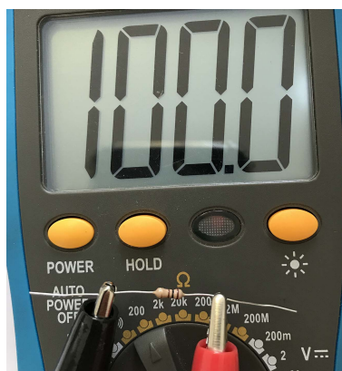
Figura 3.2 Medida de um resistor Fonte: o próprio autor
