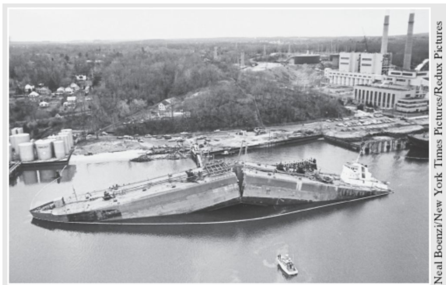
Figura 22 – Imagem do navio-tanque que se quebrou de maneira frágil
