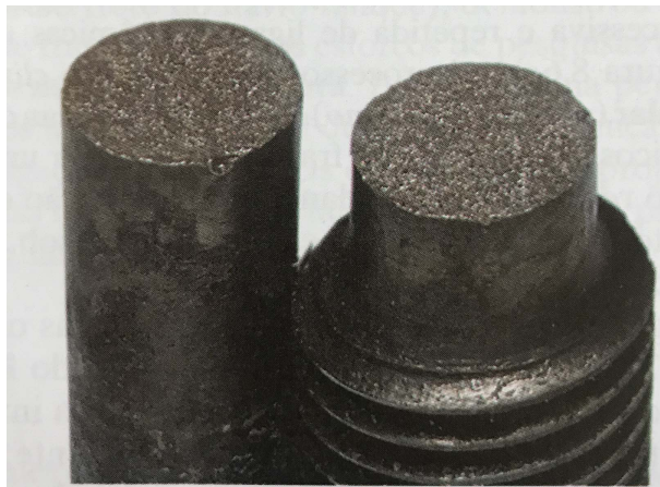
Figura 3.21 Fratura frágil em tarugo de ferro fundido - Fonte: Callister [9]
