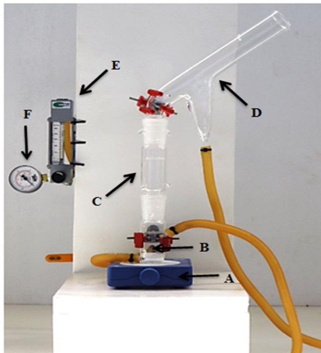
Figura 12 - Tubo de Hallimond modificado utilizado nos testes de microflotação
