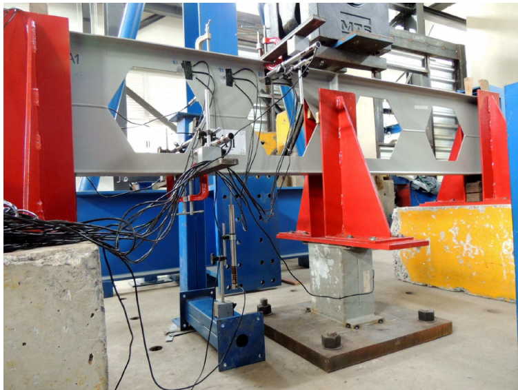
Figura 3.4 – Esquema de ensaio experimental da viga VCE18.
