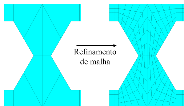
Figura 3.13 – Uma das possibilidades do refinamento de malha.
