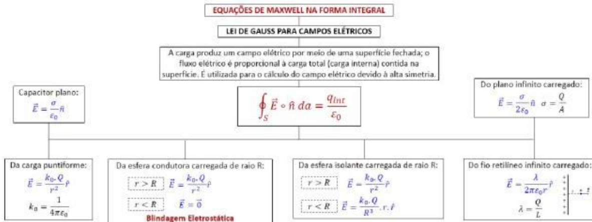
Figura 1 - Mapa conceitual da Lei de Gauss para campos elétricos - equações de Maxwell na forma integral
