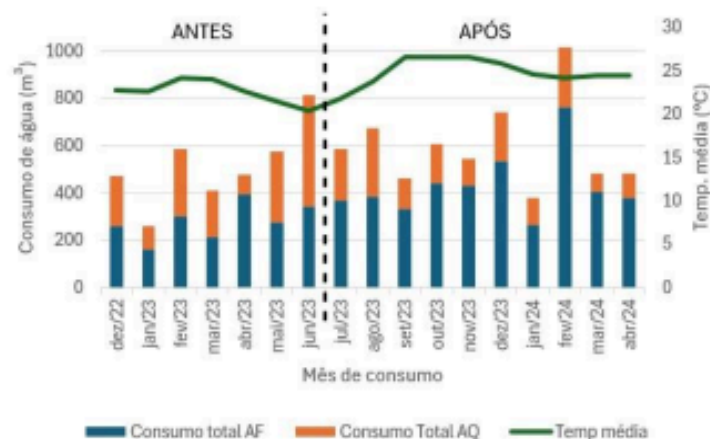
Figura 7: Consumo total mensal de água quente no edifício (m 3 ) comparado com a temperatura (°C).
