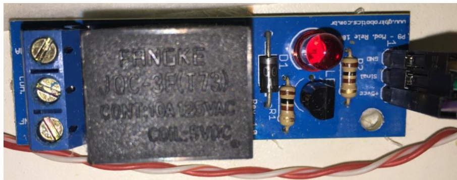
Figura 5.26 – Relé de acionamento das válvulas de controle de temperatura e umidade.
