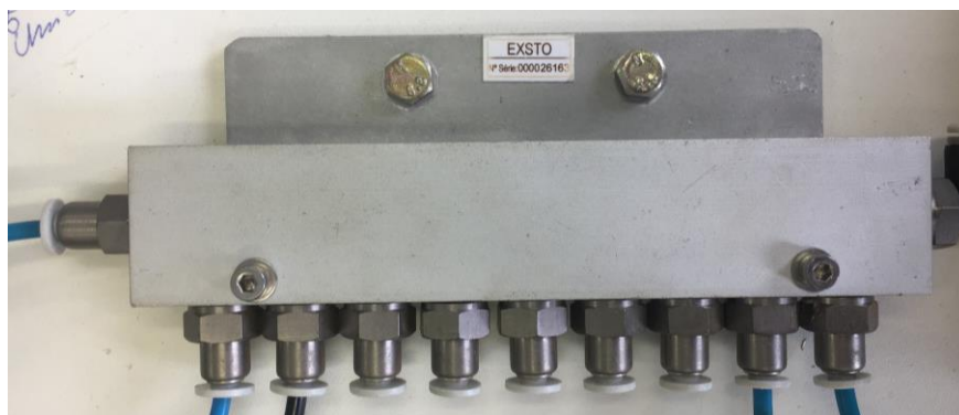
Figura 5.6 – Bloco Distribuidor em Régua de 10 saídas.
