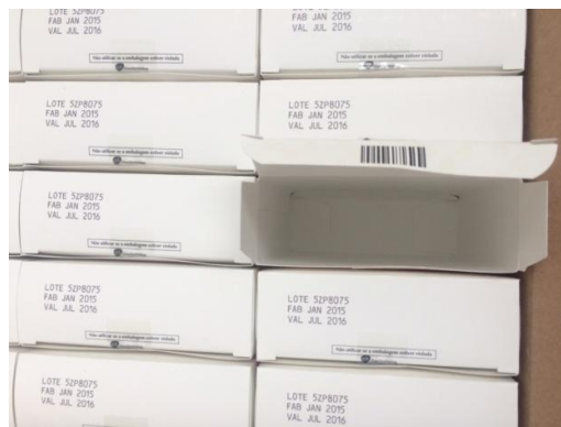
Figura 9 – Embalagem secundária com falta de embalagem primária
