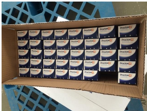
Figura 8 – Caixa de embarque com falta
